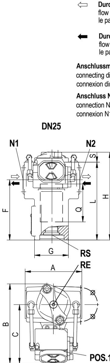
⇐ Durchflussrichtung bei Korbsiebelelementen
